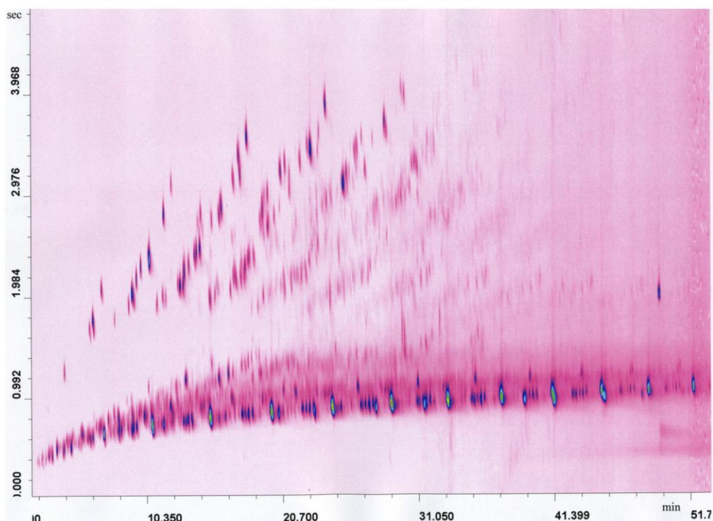
Fig. 4. FM GC  $\times$  GC-FID diesel analysis.
